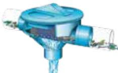
Filtro Sinus                      | 55600180 | Filtro horizontal fabricado en polietileno con malla de acero en forma de cilindro, diseñado para su instalación integrada en un realce REHC 600/580.<br>Para superficies de recogida de hasta 200 m <sup>2</sup> .<br>Diámetro de salida: 110 mm.                     | 292,00   |
