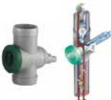
Colector filtrante | 55600150 | Filtro vertical fabricado en polietileno con malla de acero, que incorpora un adaptador para varios diámetros de tubo de recogida del agua limpia, que sale de forma perpendicular a la bajante.<br>Diámetros de entrada y salida 90 mm.                                           | 80,00    |
