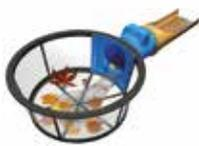
Filtro FT                         | 53620087 | Filtro horizontal fabricado en polietileno con malla de acero en forma de cesta, diseñado para su instalación integrada en el realce que incorporan los depósitos AT 70.<br>Para superficies de recogida de hasta 200 m <sup>2</sup> .<br>Diámetro de entrada: 110 mm. | 170,00   |
