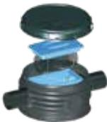
Realce Ø 400 con filtro integrado | 15600281 | Realce de Ø 400 con filtro horizontal integrado con malla de acero.<br>Apto para todos los depósitos con boca de Ø 400.<br>Para superficies de recogida de hasta 200 m <sup>2</sup> .<br>Diámetro de salida: 110 mm.                                                   | 348,00   |
